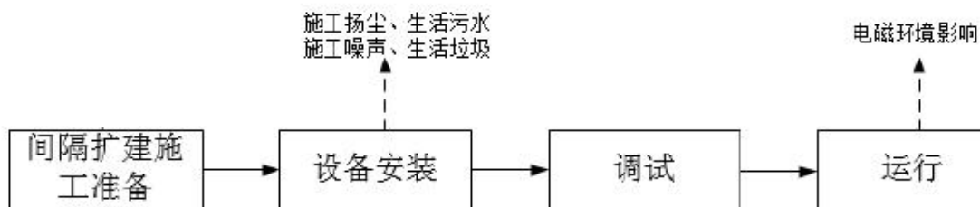
图 4-3 间隔扩建工艺流程图
